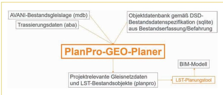
**Abb. 6:** Datenfluss bei der Anwendung des PlanPro-GEO-Planers
