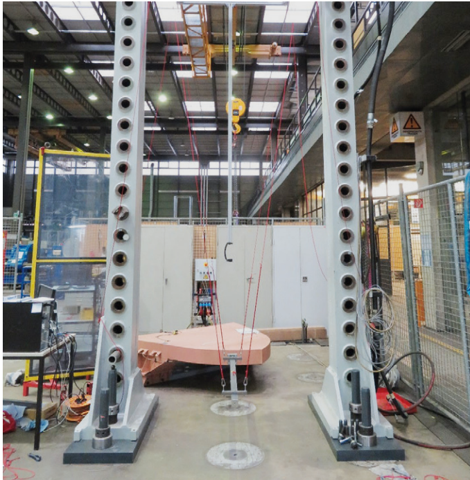
3: Test des Unterfahrschutzes des aTL mittels Fallturmversuchen
