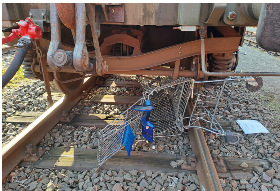
2: Tests tatsächlicher Überrollereignisse mit Flachwagen
