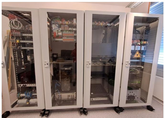
**Bild 4: Static Mockup Unit (SMU), die im Projekt Automated Train für HIL-Tests verwendet wird**
