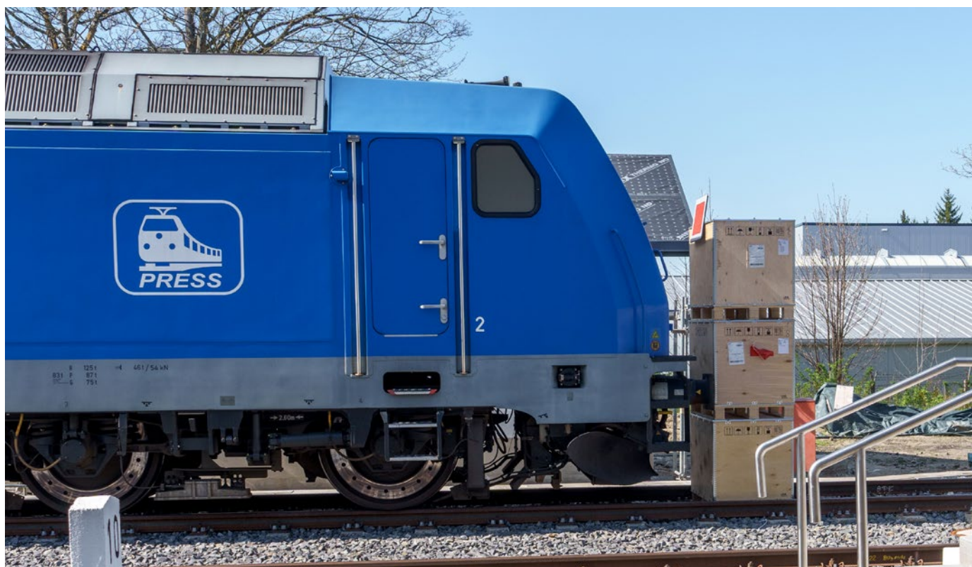
Bild 3: Testfahrzeug der Baureihe 285, vor einem aufgebauten Hindernis
