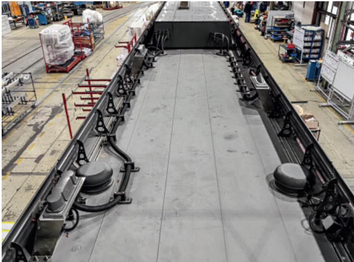
Drei aufgeständerte Antennen auf dem Dach der BR 430 (links vorne und hinten für FRMCS, rechts für öffentlichen Mobilfunk) (Foto: Alstom).
