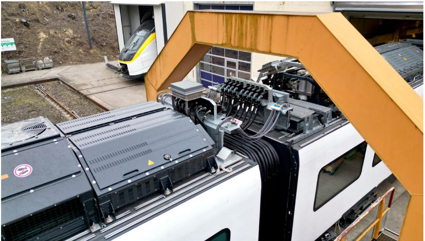
**Bild 2: 4x4-Antennen, die für alle drei Funksysteme genutzt werden können, auf dem Dach eines Coradia Max**
