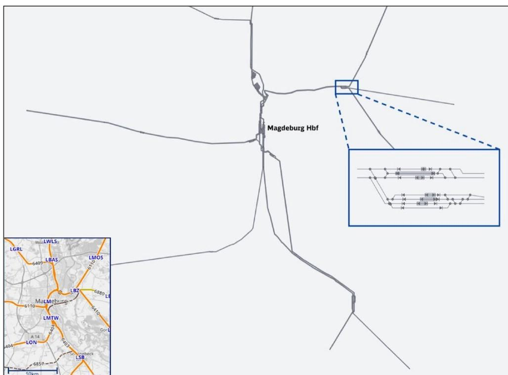
**Bild 2: Großes Bild:** Netzausschnitt um Magdeburg Hauptbahnhof mit 29 Bahnhöfen, 343 Gleiskilometern (Anwendungsfall 2a und 2b), **kleines Bild links:** geographische Darstellung, **kleines Bild rechts:** Betriebsstelle Biederitz (Anwendungsfall 1)
