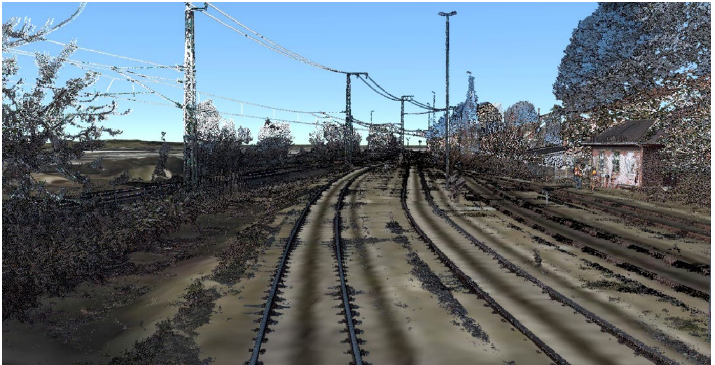
Abb. 1: Kinematisch eingemessene Punktwolke
