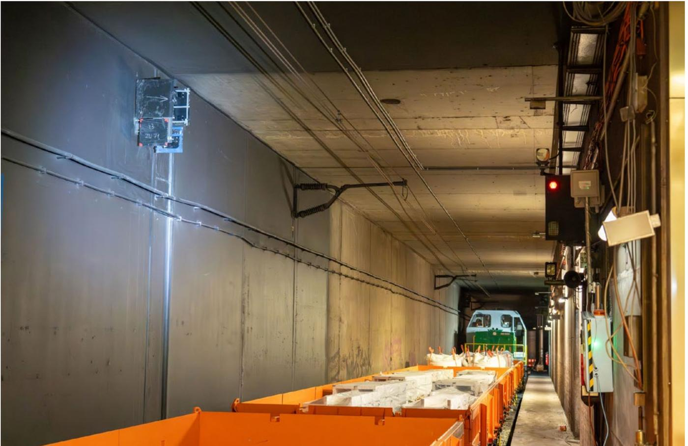
**Abb. 3:** Bauzug auf der S-Bahn-Stammstrecke im September 2024, mit abgedeckten ETCS-Halttafeln (links, Rücken an Rücken) und Lichthauptsignal (rechts)
