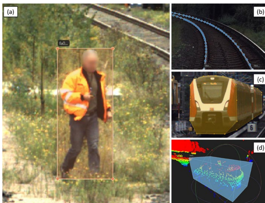
Abb. 1: Übersicht über die Annotationstypen Bounding Box (a), Polyline (b), Polygon (c) und 3D-Bounding-Box (d)
