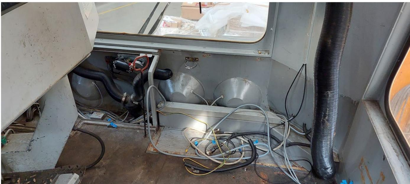
**Abb. 3:** Im Zuge der begonnenen FoC-Umrüstung wurde u. a. das Führerpult ausgebaut.
