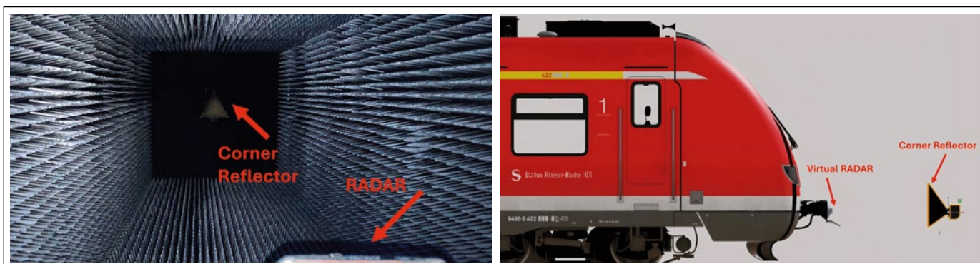
Bild 3: Links: statischer Messaufbau zur Erfassung realer Radardaten in einer Radarabsorberkammer. Rechts: virtuelle Zugszene in NVIDIA Isaac Sim mit einem auf dem Zug montierten Radarsensor und einem Tripelspiegel als Testobjekt
