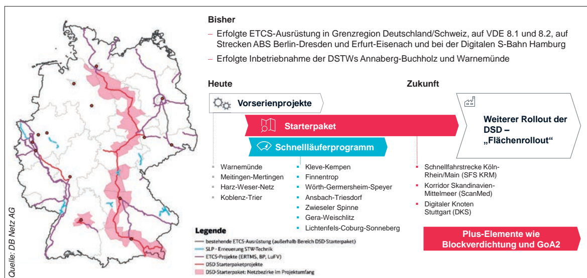
Abbildung 1: Mit den Starterpaket-Projekten des betrieblich-technischen Zielbildes beginnt die Digitalisierung der Bestandsfunktionen auf der Grundlage von digitalen Stellwerken (DSTW) und ETCS L2
