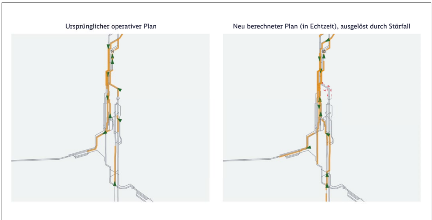
Abb. 4: Der CTMS-Prototyp reagiert selbstständig auf einen gemeldeten Störfall (die rot markierten Gleise wurden gesperrt); links der ursprünglich auf Basis von EVU-Anfragen erzeugte Plan; rechts der im Betrieb abgeänderte Plan
