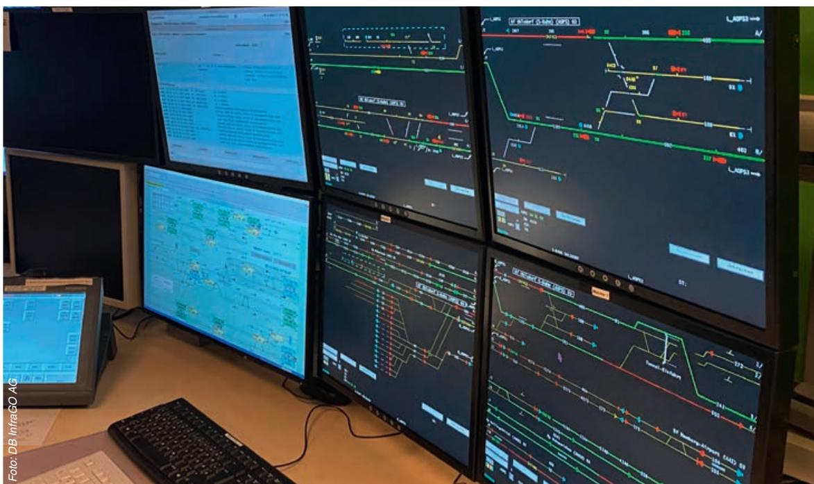
ESTW-Bedienoberfläche des Herstellers Siemens
